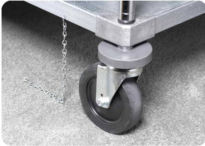
รถเข็นของควรจะมีการต่อสายดินและมีอุปกรณ์กันกระแทก
